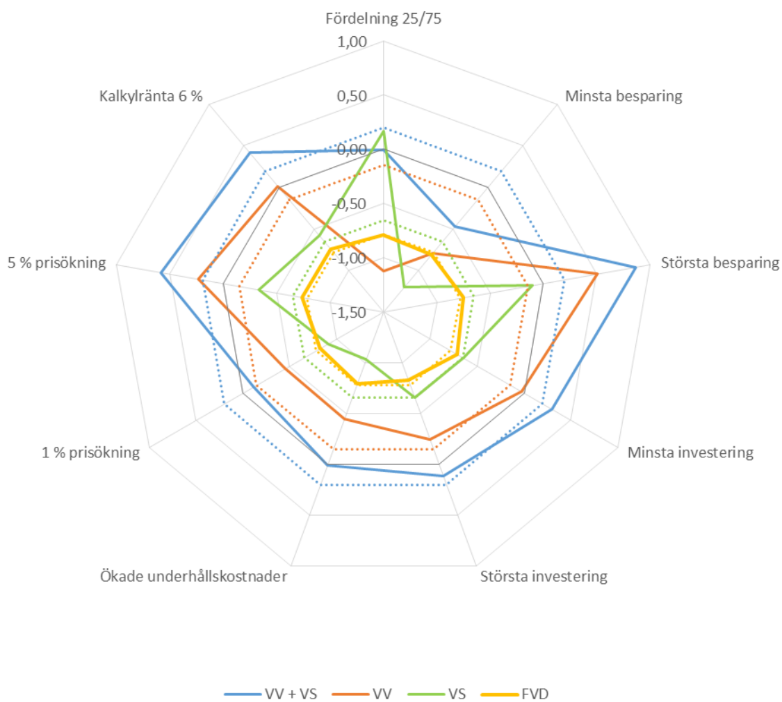
Figur 21. Sammanfattning av nettonuvärdeskvoten för alla installationsalternativ samt för alla parametrar som varierats i känslighetsanalysen. VV+VS visas i blått, VV i orange, VS i grönt och FVD i gult där motsvarande punktade linjer i samma färg är värdet för basscenariot.
